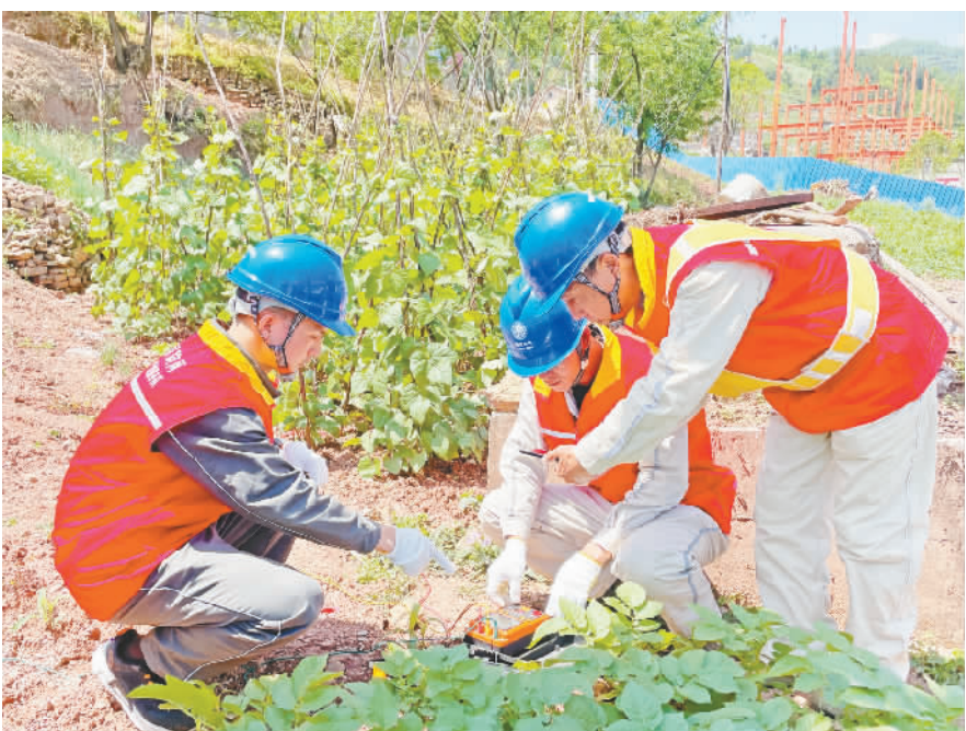
国网巫山供电公司组织红岩共产党员服务队对石里6号台区等进行接地电阻遥测。
