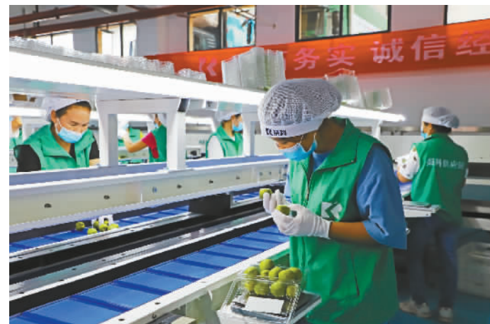
巫山脆李产地仓通过脆李分选设备代替人工分级分选，大幅提高工作效率。
