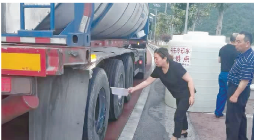
图为冷冷却水提供点,正在给一辆刚到的货车刹车装置浇水降温。
