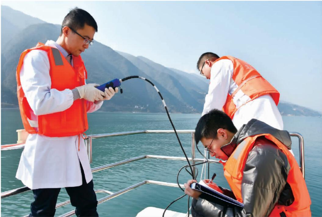
魏嵬(左)在巫峡境内红石梁长江断面现场检测水温、PH值、溶解氧等参数。
